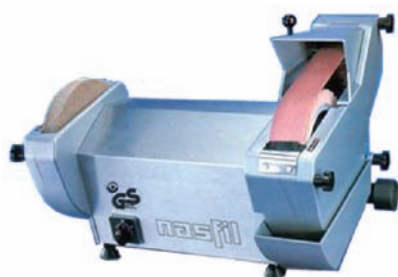
Nasfil Slipemaskin Vannkjøling på båndet gir mindre varmegang av kniven. Våtbånd 50x850mm P120 Filtskive 200mm Spenning: 230/400V - 3 fas, 50Hz/550W Vekt: 21kg
