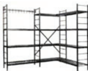
Hylleinnredning som er beregnet for kjøle- -fryse og lagerrom. Aluminium eller rustfritt strål. Ribbe eller tette hyller. Montering uten bruk av verktøy. Ramme høyde 1450 / 1770 / 2090mm Lengde på hyllene: 600 / 800 / 900 / 1000 / 1100 / 1200 / 1400 / 1500mm Dybde på hyllene: 300 / 400 / 500 / 600mm.
