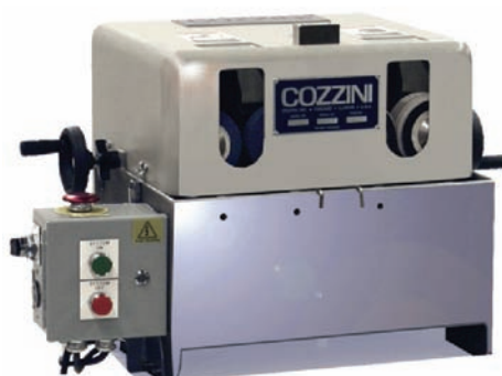
Cozzini Den optimale maskinen med stående stener. Perfekt for bedrifter som ønsker sentralsliping og har 12 knivbrukere eller flere. 2 sett stående stener. Venstreside lager hulkil for slankere egg. Høyreside setter opp eggen. Med sine unike egenskaper reduserer den knivforbruket med 50% og man oppnår samme skarphet og vinkel på kniven hver gang. Våtsliping med kjølevæske som også smører og desinfiserer. Spenning: 230V - 1 fas, 50Hz Vekt: 45kg Finnes også i større modeller
