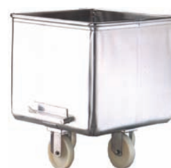
Tilbringervogn Den originale tilbringervogn laget av 2mm rustfritt stål SS 2333 Forsterket toppvulst. Kalibrert vekt.: 40 kg Volum: 200 liter 4 stk. nylonhjul: 160mm diameter
