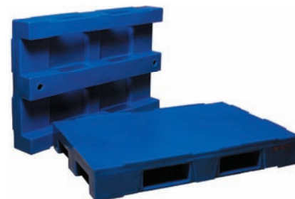
Plastpall med og uten kant 800x120x155cm næringsmiddelgodkjent polyetylen (LLD) med glatte overflater som forenkler rengjøring. Maks belastning: 2000kg på gulv og 800kg i pallereol. Vnr. 2500300
